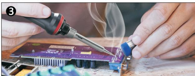
La soudure vient de l'autre côté lorsque la surface de soudure est chauffée et que la soudure à l'étain commence à fondre.
