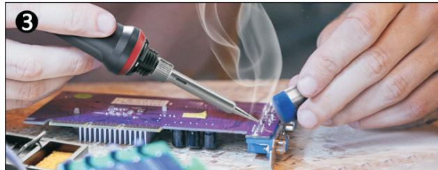
La saldatura proviene dall'altro lato quando la superficie di saldatura si riscalda e la saldatura a stagno inizia a fondere.
