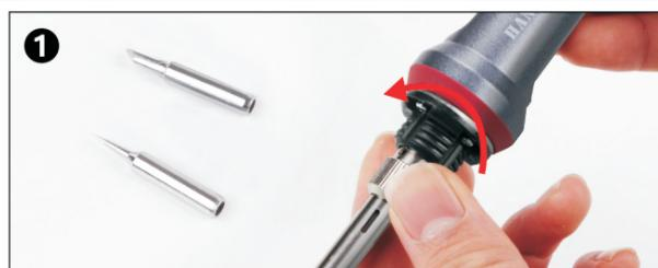
Lösen Sie die Eisenschraube und ziehen Sie den Deckel ab.
