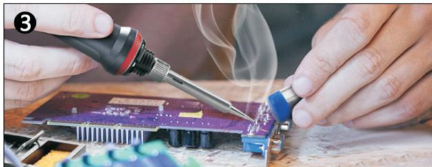
La soldadura proviene del otro lado cuando la superficie de soldadura se calienta y la soldadura de estaño comienza a derretirse.
