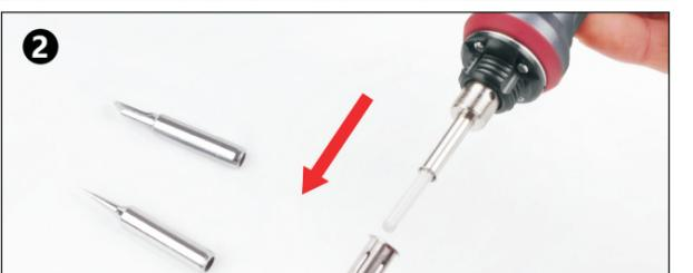
Entfernen Sie die ursprüngliche Eisenspitze.
