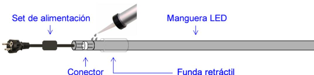
4 Desplazar la funda retráctil hasta cubrir la unión entre el set de alimentación y la manguera LED.
